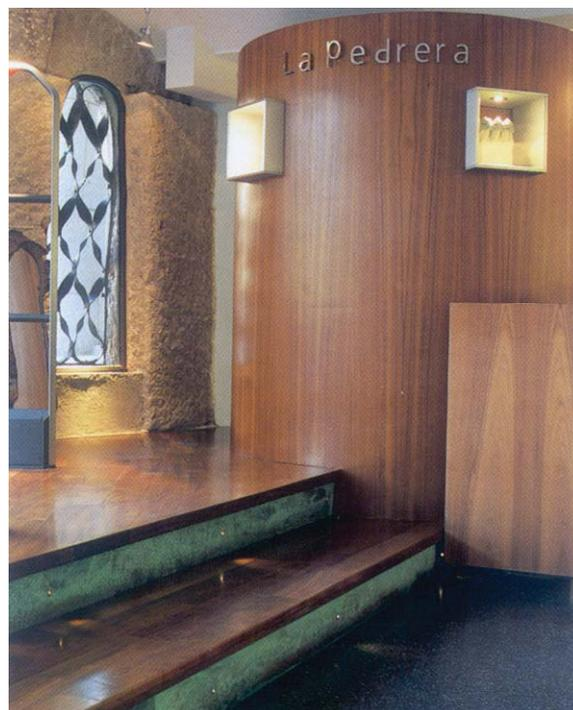
En este proyecto se ha utilizado fibra óptica para el balizamiento de las escaleras de acceso exteriores y para las escaleras de subida a la primera planta. La fibra óptica en este caso es completamente invisible, aparece únicamente el punto de luz, integrándose en el entorno.
